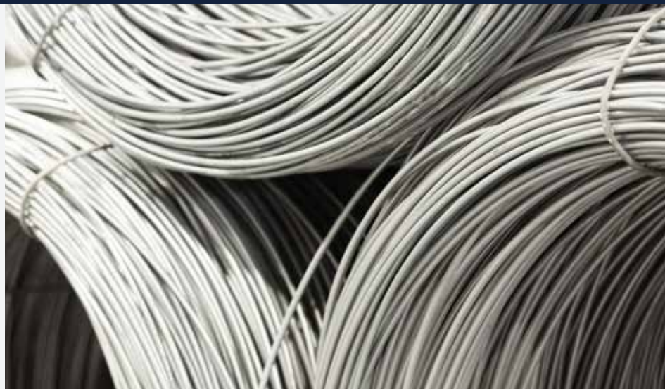
Stahl vor der Sendzimirverzinkung
